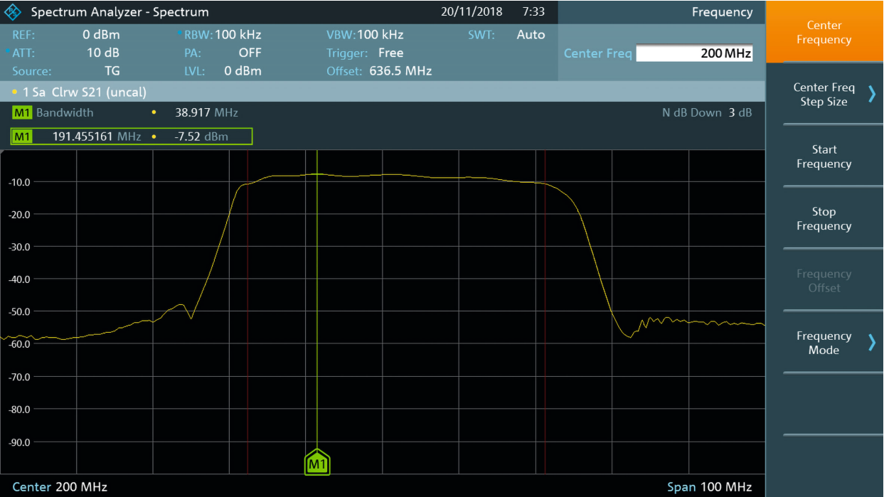
R&S®FPC1500：测量包含混频器、滤波器和放大器的信号链的跟踪源
