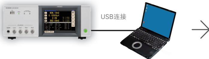
标配可通过计算机设置的频率进行扫频的同时将测量数据转换成Excel文件的应用软件。
