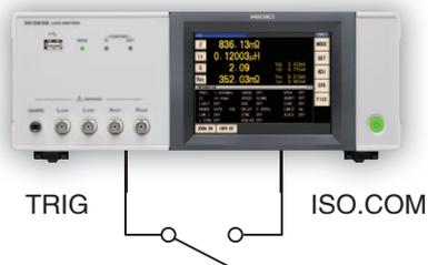
出发设置选择“外部触发”，EXT.I/O端口的TRIG中可通过脚踏开关外部控制测量&保存。
