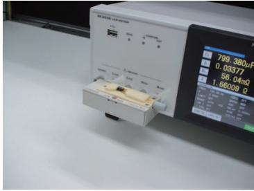
电容测量时测量信号可与直流电压重叠测量。
