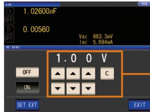
可发出电压范围DC 0V ~ 2.50V(10mV分辨率)。(低Z高精度模式时: 0V ~ 1V)
