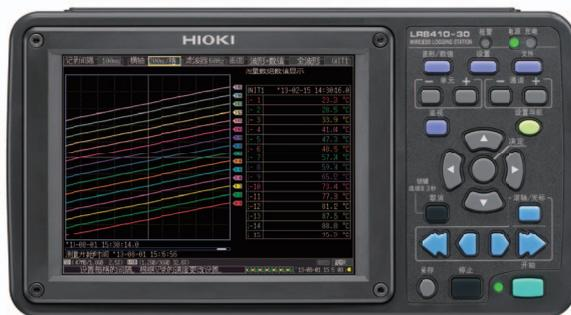
测量单元·无线数采与LR8410-30的通讯距离为无遮挡物30m。若有遮挡物(墙壁,金属等),通讯距离将缩短。
